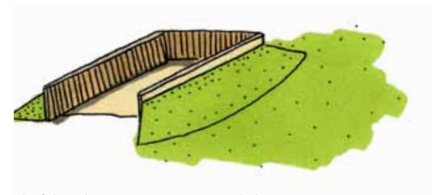
Sleufsilos ed. WEL inpassen met grastalud
